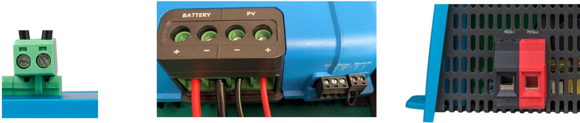
Pele una longitud suficiente del aislante del cable antes de meter el extremo desnudo en la cavidad del conector. Evite que el aislamiento del cable entre en el conector. Esto puede producir una resistencia demasiado alta y el conector se calentará y podría llegar a derretirse. No deje que se vea cable sin aislamiento (cable pelado) en la parte exterior del conector. Esto es peligroso ya que puede causar electrocución o un cortocircuito.
