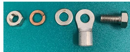
Use herramientas aisladas para apretar la tuerca. Un cortocircuito accidental de una batería puede ser muy peligroso, y las corrientes pueden derretir su llave inglesa sin aislar o las chispas pueden hacer que la batería explote.
